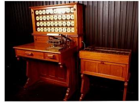
"Tabulatrice" ou "machine à statistique" construite par H.Hollerith pour (concours) le recensement américain de 1890. Brevet déposé le 8 juin 1887. Source : Tabulatrice, selezionatrice e perforatrice hollerith - Museo scienza tecnologia Milano - Repris sur : https://fr.wikipedia.org/wiki/Herman_Hollerith
