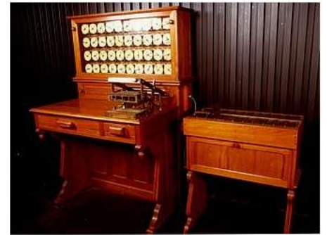
"Tabulatrice" ou "machine à statistique" construite par H.Hollerith pour (concours) le recensement américain de 1890. Brevet déposé le 8 juin 1887. Source : Tabulatrice, selezionatrice e perforatrice hollerith - Museo scienza tecnologia Milano - Repris sur : https://fr.wikipedia.org/wiki/Herman_Hollerith
